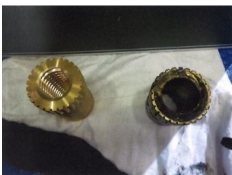
森山揚水機場（山之上町地内） 補修（電動仕切弁部品取替）
